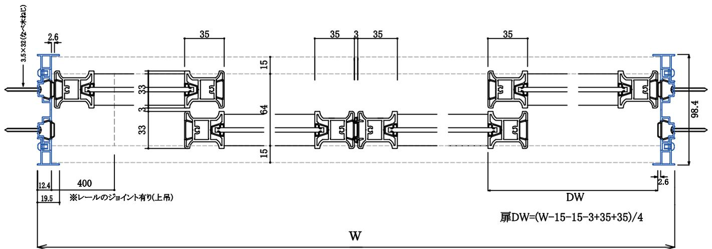
□縦枠アルミ付 納まり参考図 (よこ断面)
