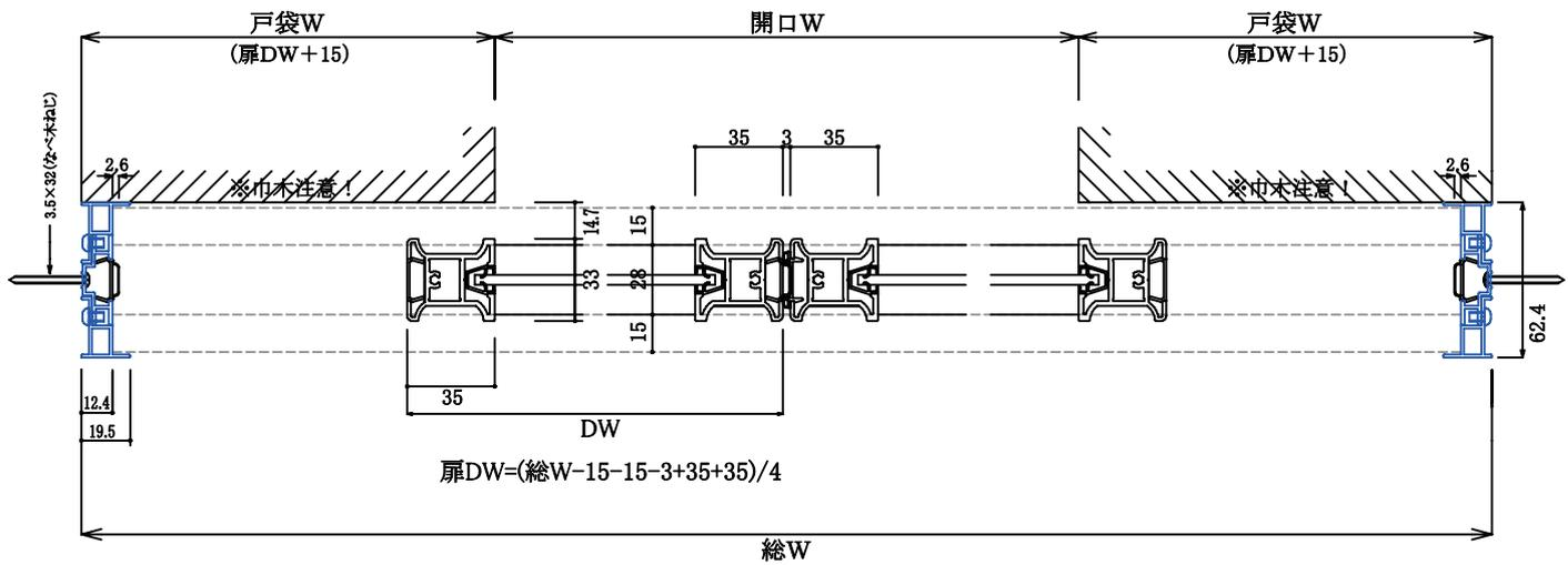
□縦枠アルミ付 納まり参考図 (よこ断面)
