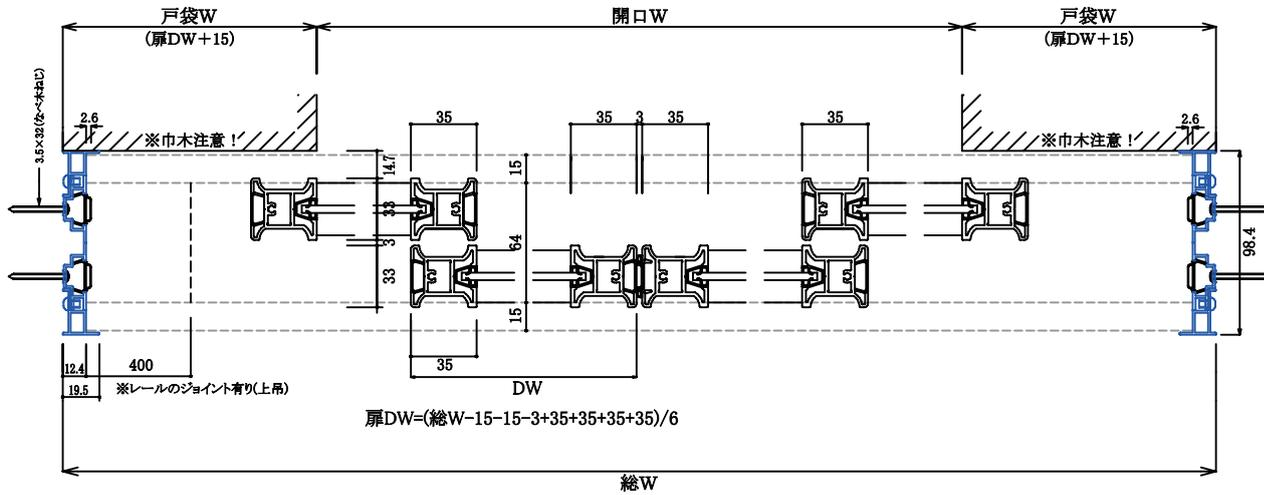
□縦枠アルミ付 納まり参考図 (たて断面)
