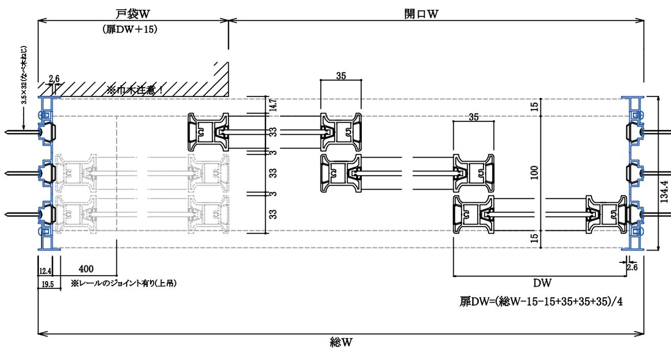
□縦枠アルミ付 納まり参考図 (よこ断面)
